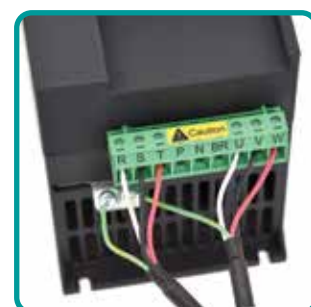
Подвод кабелей снизу
